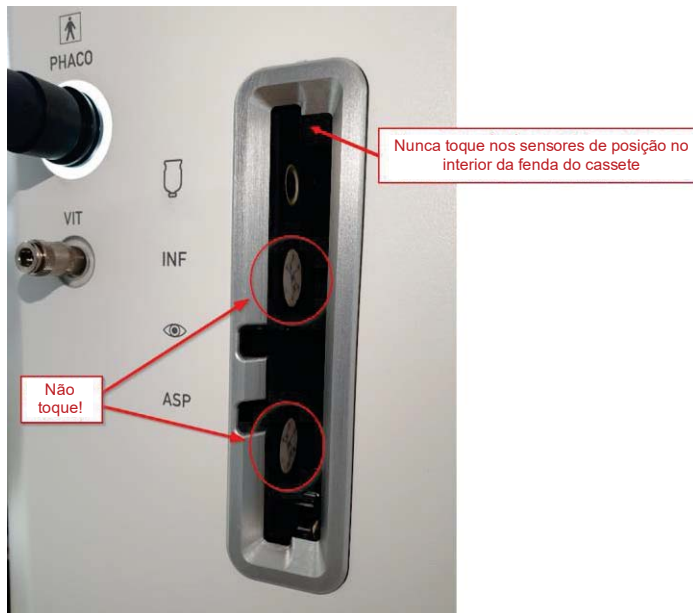
Figura 37: Proteja os sensores do sistema do cassete
